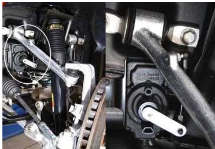
Figura 10 - Sensor de deslocamento na suspensão dianteira de um Corvette. (Crivellaro, 2008)
